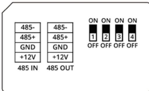
Ogni modulo di espansione deve avere un indirizzo univoco. Questo indirizzo viene impostato tramite i 4 DIP switch presenti sul modulo.
